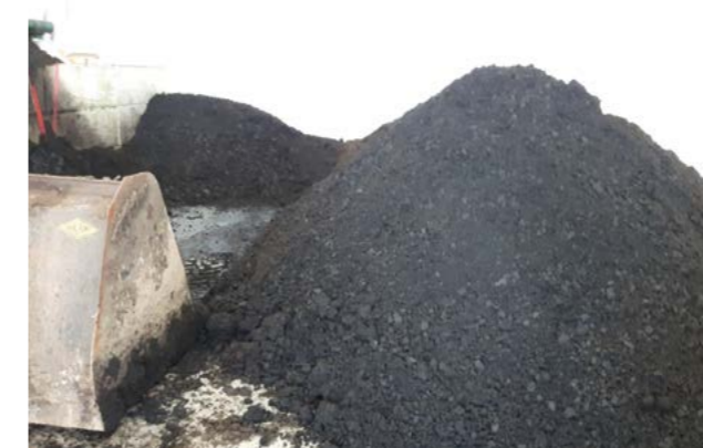
水気を切った固形物の乾燥物質含有率は約30%であり、輸送が容易で栄養豊富な肥料として利用されます。
