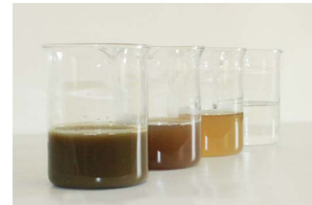
液体肥料の固形物は、4つのプロセス・ステップで水から分離されます。その結果、水、濃縮栄養物、固形肥料が生じます。
